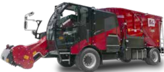
V-MIX DRIVE MAXIMUS GIANT 19 TOT 23-25 MENGWAGENS MET 2 VIJZELS
