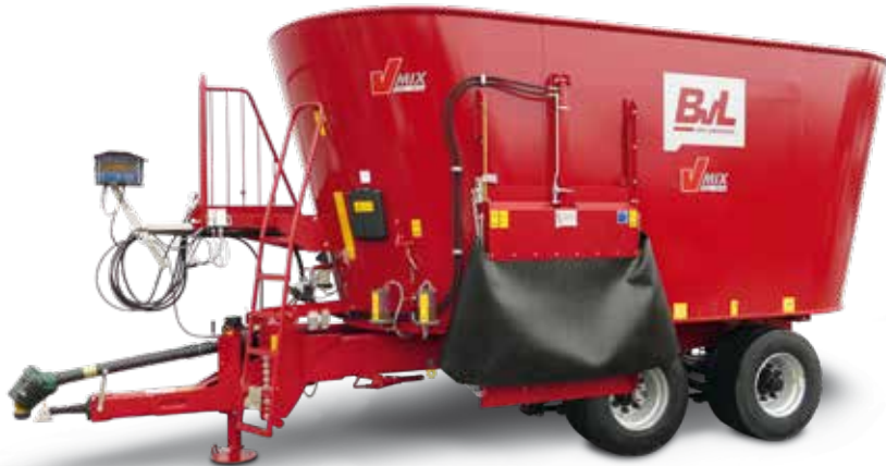
Mélangeuse à deux vis sans fin dotée d'une gros volume
