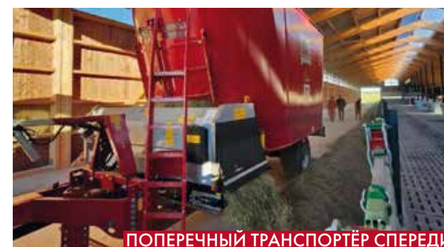
ПОПЕРЕЧНЫЙ ТРАНСПОРТЁР СПЕРЕДИ
