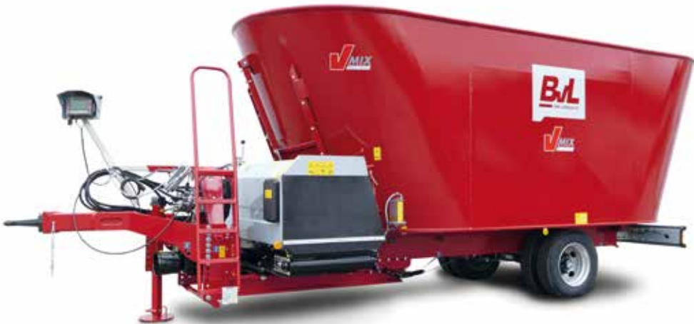
Компактный кормосмеситель с двумя шнеками
