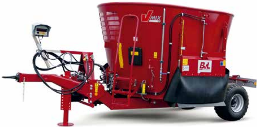
Кормосмеситель с низкой посадкой для низких проездов
