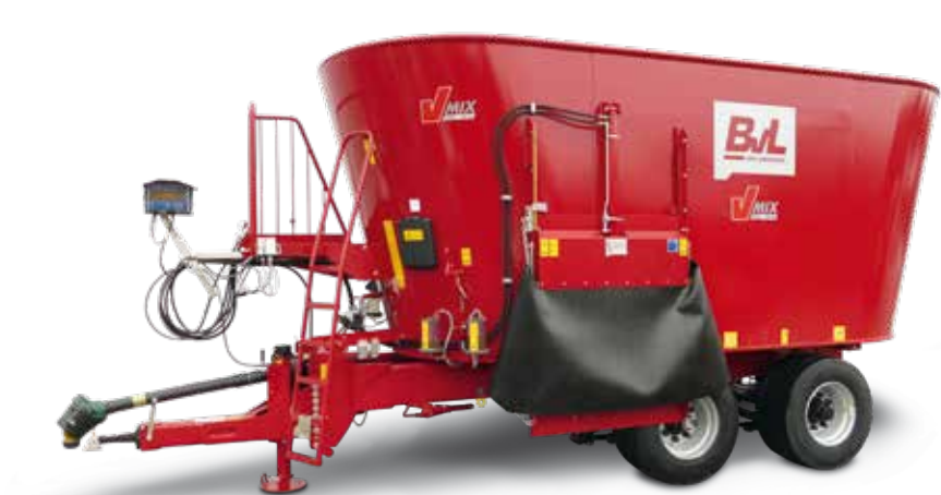
Двухшнековый кормосмеситель с большим объёмом
