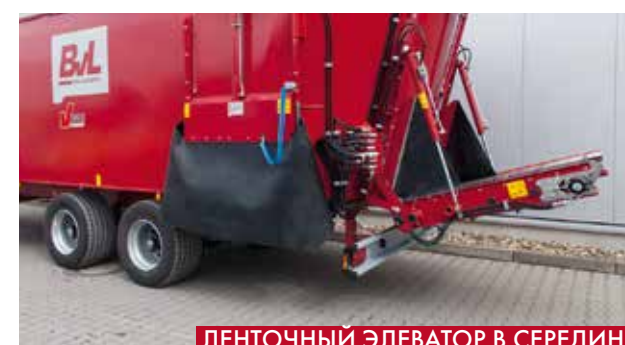
ЛЕНТОЧНЫЙ ЭЛЕВАТОР В СЕРЕДИНЕ
