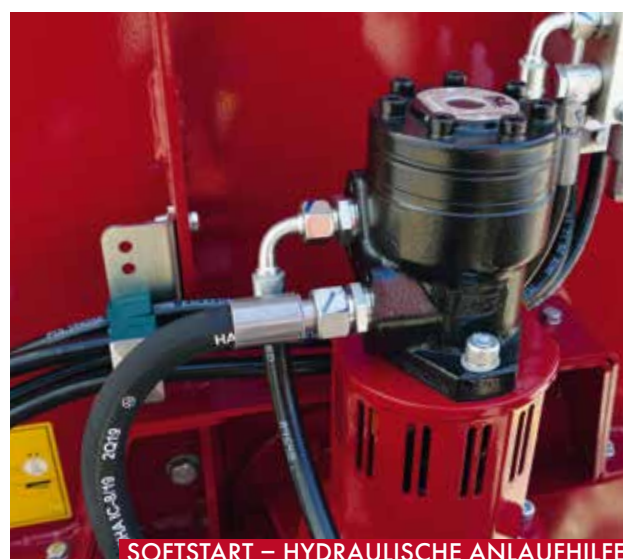
SOFTSTART – HYDRAULISCHE ANLAUFHILFE
