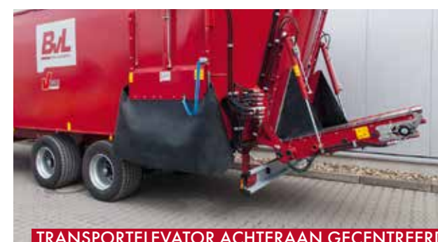
TRANSPORTELEVATOR ACHTERAAN GECEN
