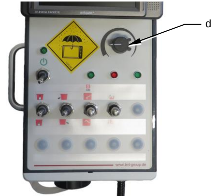
Abb. 7-28: Drehregler für Bandgeschwindigkeit am Bedienpult
