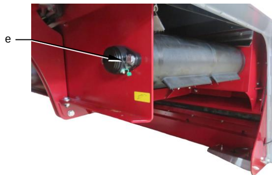
Abb. 8-6: Schmiernippel der Lager am Querförderband
