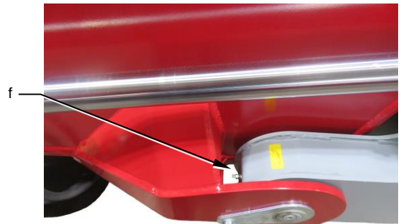
Abb. 8-7: Schmiernippel am Drehpunkt der Ladeklappe
