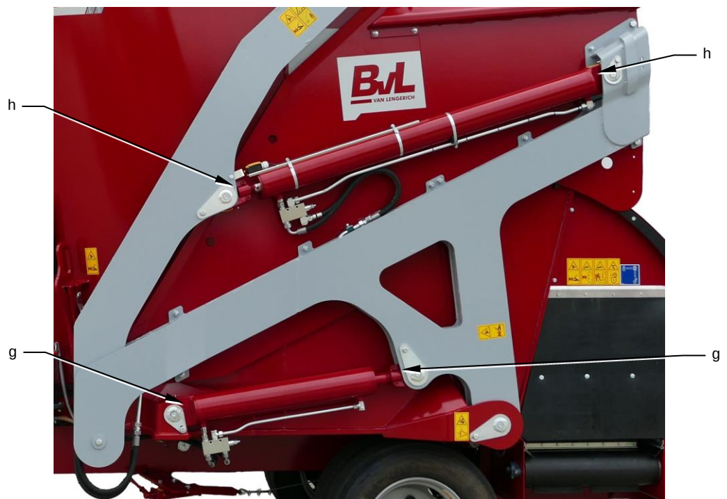
Abb. 8-8: Kugelgelenk am hydr. Zylinder der Ladeklappe und der Schneidrahmschwinge
