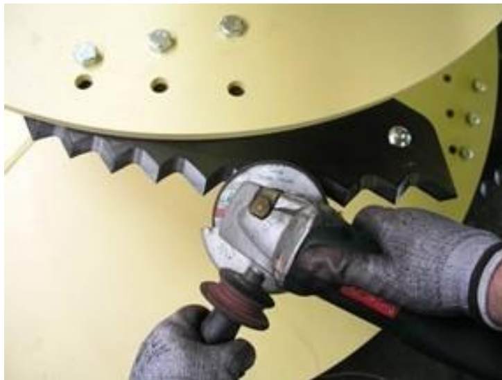
Abb. 8-23: Schneidmesser der Mischschnecke.
