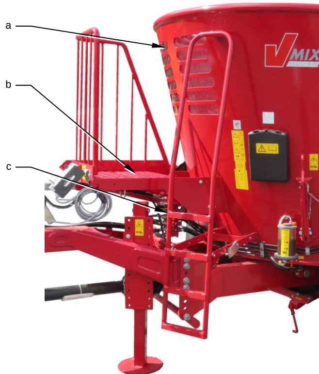
Abb. 4-24: Arbeitspodest und Sichtfenster
