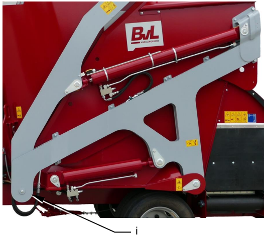
Abb. 8-9: Schmiernippel am Drehpunkt der Schneidrahmenschwinge
