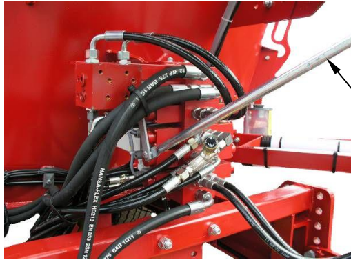
Abb. 7-27: Schwenkhebel am Stromregelventil für Bandgeschwindigkeit
